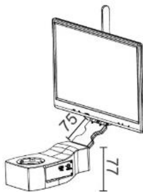
Moduł pośredni z kamerą do montażu na mikroskopach Nikon, Olympus, Leica, Zeiss
